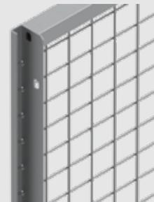
Perfil panel chapa 3 mm plegada 50 x 26 x 15 mm soldado sobre tubos de 40 x 30 x 1,5 mm. Por el perfil encajan las puntas de la malla para que no se queden por el exterior. Acabado sin aristas ni alambres
