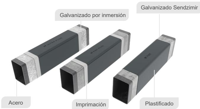
Todos los acabados, tienen una capa nanotecnológica de pasivado entre el acero y la imprimación o plastificado.
